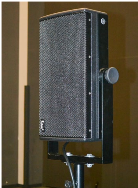
Kompaktowy, dwudrożny zestaw głośnikowy VR8, wyposażony w przetwornik Pro Ribbon, charakteryzuje się zaskakująco szerokim pasmem pracy.
